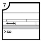
Abstände zwischen kurzen Enden: Der Mindestabstand zwischen den Kopfstößen in benachbarten Reihen darf nicht kleiner als 50 cm sein. Dies ist für die Stabilität des Bodens notwendig.
