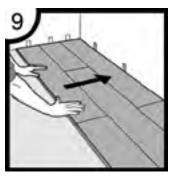
Nach 2–3 Reihen: Stellen Sie den nötigen Abstand von 15 mm zur längsseitigen Wand durch Abstandshalter her. Danach fahren Sie mit der Verlegung wie oben beschrieben fort.
