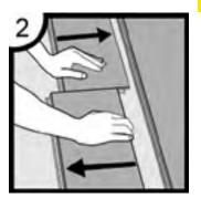
Der Bodenbelag kann einfach entfernt werden, was das Ersetzen während und nach der Verlegung ermöglicht. Trennen Sie eine ganze Reihe, indem Sie sie vorsichtig anheben und leicht auf die Verbindungsstelle klopfen. Klappen Sie die lange Seite zum Entfernen hoch.
