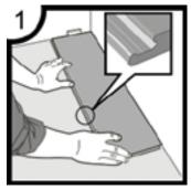
Erste Diele, erste Reihe: Platzieren Sie einen Abstandshalter von 15 mm Breite zwischen dem linken Ende der Dielen und der linken Wand und schieben Sie die Diele dagegen. Nachdem Sie 3 Dielenreihen verlegt haben, können Sie den Bodenbelag an der längsseitigen Wand mit 15 mm Abstand positionieren.
