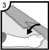
Klappen Sie die Diele in einer Bewegung herunter. Stellen Sie während des Herunter-klappens sicher, dass die Dielen dicht aneinander liegen. Drücken Sie danach das kurze Ende nach unten, bis es hörbar klickt. Es ist keine größere Kraft erforderlich.
