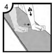
Drücken Sie leicht auf das gerade installierte, kurze Ende.
