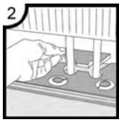
Bohren Sie Löcher, die 18 mm größer sind als der Durchmesser der Rohre. Schneiden Sie die Diele aus (mit der dünnsten verfügbaren Klinge). Verlegen Sie die Diele und kleben Sie das ausgeschnittene Stück wieder fest.
