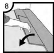
Zweite Diele, zweite Reihe: Platzieren Sie die Diele schräg in die Nut der vorherigen Reihe und stellen Sie dabei sicher, dass das Kopfende der Diele eng/bündig an das Kopfende der vorherigen Diele anliegt.
