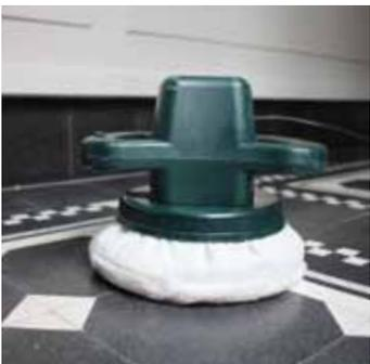
zum Ausgang hin. Das Ölen und Einpolieren erfolgt am besten zu zweit. Der Boden kann nach einem Tag begangen werden. Die vollständige Aushärtung des Öls ist nach sieben Tagen erfolgt. In dieser Zeit sollte der Boden nicht gereinigt werden.
